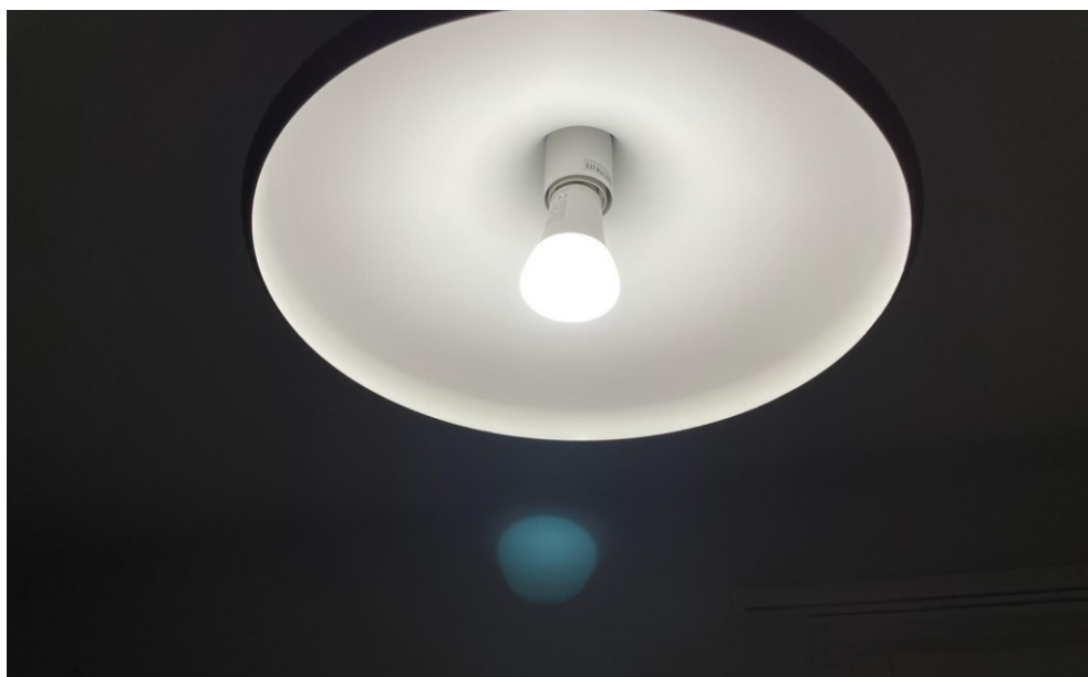
Slika 51: Primer ghost flare , ko je žarnica povsem ostro zrcalno preslikana. (vir: forums.macrumors.com)
